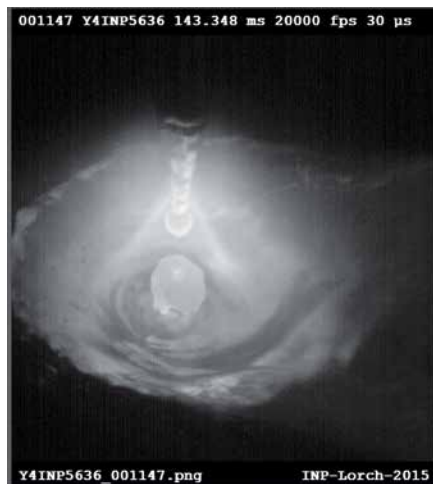
Bild 2: Der Primärtropfen hat sich gelöst und die Sekundärtropfen bilden sich.
