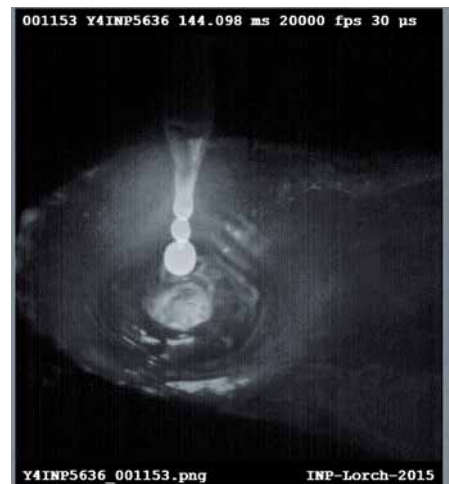
Bild 3: Der Primärtropfen geht ins Schmelzbad über und die Sekundärtropfen lösen sich.
